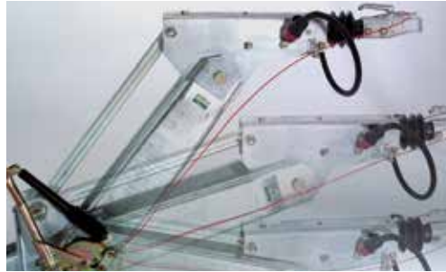
Höhenverstellbare Zugdeichsel (Kugelpkopfkupplung und DIN-Zugöse nicht inklusive)
