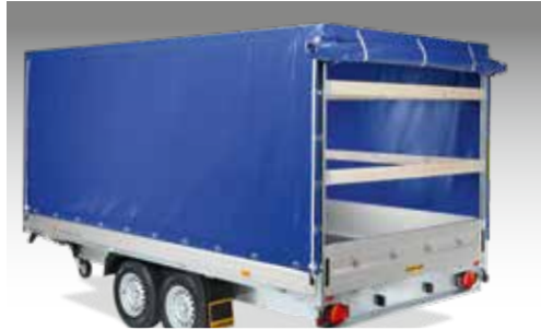
Plane & Spiegel, Ladehöhe 1.300 mm, 1.600 mm, 1.800 mm und 2.000 mm; Plane in verschiedenen Farben erhältlich
